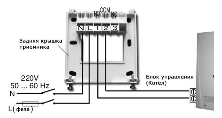
Приёмник подключается к сети напряжением 220В, 50Гц. Ноль подключается к точке N, а фаза к точке L. Советуем делать монтаж через вилку, чтобы можно было выключить приёмник при необходимости. Приёмник руководит работой котла при помощи реле с точками подключения 1 (NO), 2 (COM), 3 (NC). Для управления обогревающим прибором - котлом приёмник подключается к точкам 1 (NO) и 2 (COM), а для управления охлаждением - кондиционером приёмник подключается к точкам 2 (COM) и 3 (NC).
